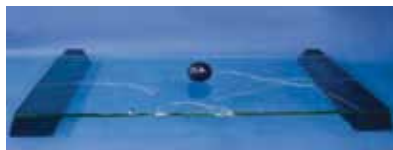
Laminirano sigurnosno staklo od 2 toplinski ojačana stakla - obadje razbijene ploče
