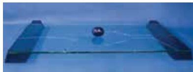
Laminirano sigurnosno staklo od 2 toplinski ojačana stakla
